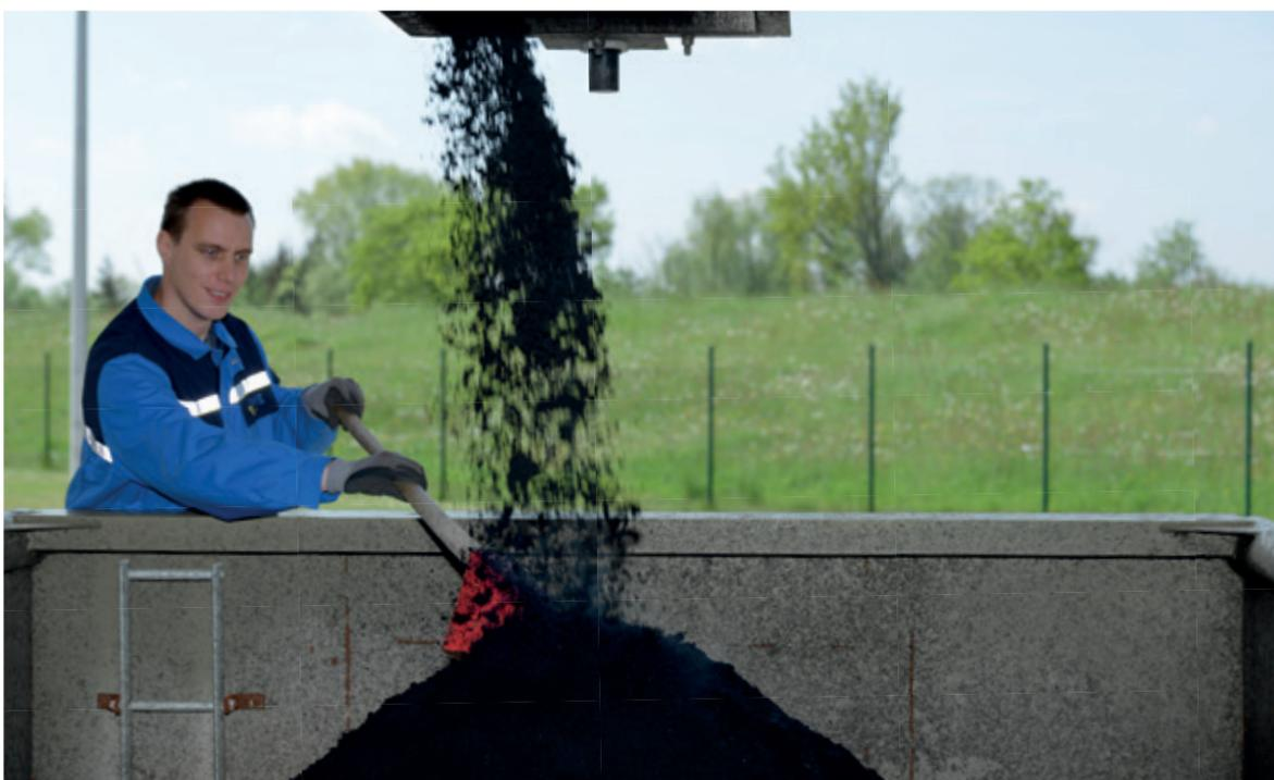
Abbildung 8: Mittels entsprechender Absetzmulden wird der entwässerte Klärschlamm zur Verwertung gebracht.
