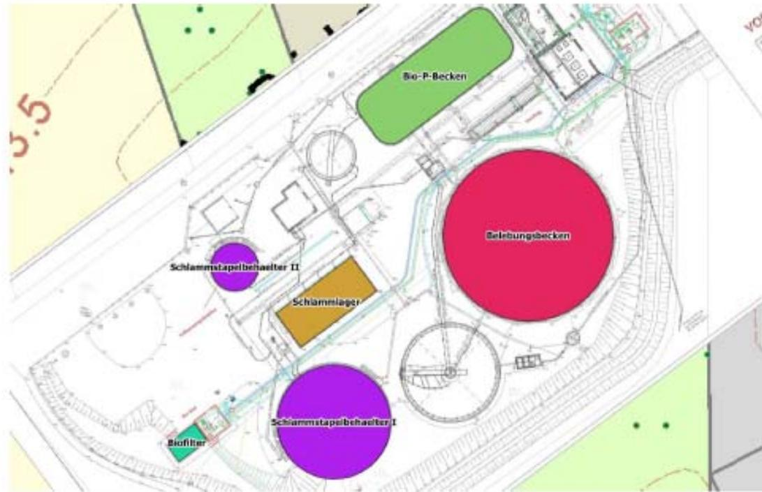
Abbildung 1: Emissionsrelevante Bereiche auf dem Anlagengelände; die farbliche Kennzeichnung weist aus, welche Bereiche hinsichtlich des Emissionsverhaltens vergleichbar sind.
