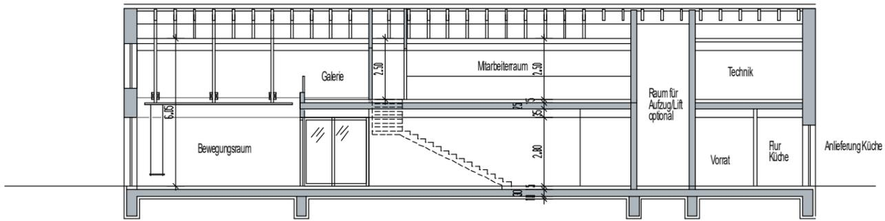
Schnitt C-C mit ausgebautem Dach über Bewegungsraum
