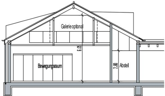
Schnitt B-B mit ausgebautem Dach über Bewegungsraum
